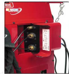
Sistema de Conexión Fácil para la Antorcha Pro-Torch TIG, no necesita de adaptadores.
